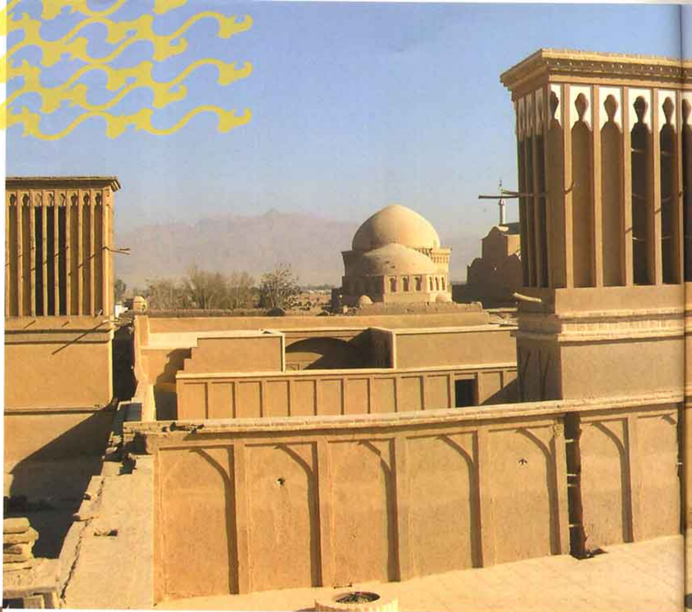
Schémas de ventilation naturelle : les tours des vents permettent la ventilation du réservoir en évitant de souiller l'eau par le sable porté par le vent et la maintiennent fraîche.
